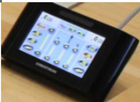
Pour activer la console, passez votre main au dessus, l'écran s'allume et les fonctions de réglage apparaissent.
