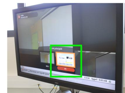
**Au préalable,** raccordez la prise VGA d'un ordinateur portable au terminal de visio par le biais du câble VGA "visioconférence" situé à proximité du moniteur.
